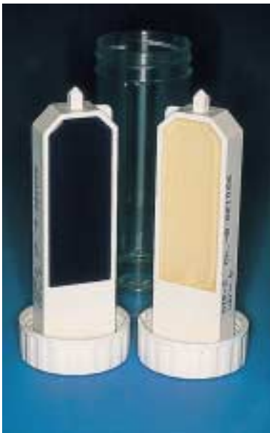
Abb. 9 Durch die unterschiedlichen spezifischen Nährböden auf Vorder- und Rückseite ermöglicht der CRT-Test der Firma Vivadent den gleichzeitigen Nachweis von Mutans-Streptokokken und Laktobazillen.
