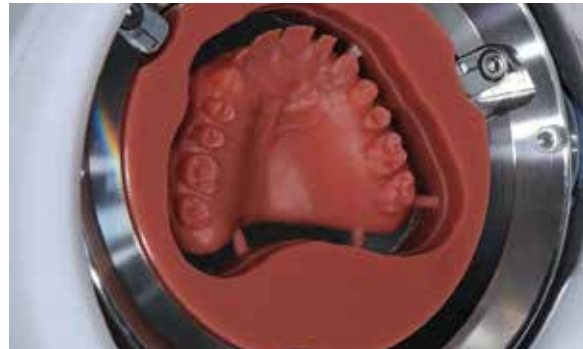
Abb. 5: CNC-Fräsen einer Oberkiefer-Totalprothese.
