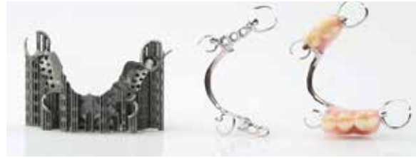
Abb. 4: Im Lasersinterverfahren hergestellte Unterkiefer-Modellguss-Prothese (DMLS-Verfahren = Direct Metal-Laser-Sintering) (Bildquelle: EOS GmbH, Krailling).
