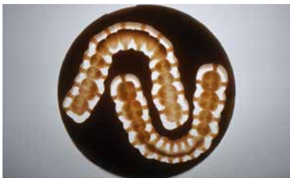
Abb. 3: Vollanatomische zahnfarbene Aufbisschienen in einer Fräsronde aus Hochleistungspolymer.
